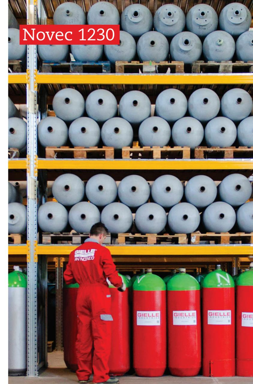
Gielle realizza impianti a Novoc 1230. Il Novoc™ 1230 è un materiale di alto peso molecolare, rispetto agli halons della prima generazione. Il prodotto ha un calore di vaporizzazione di 88.1 kJ/kg. Anche se è un liquido a temperatura ambiente si vaporizza subito dopo essere scaricato in un sistema di inondazione totale.
